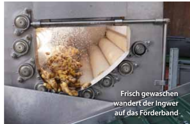
In der Ingwerwaschmaschine werden die scharfen Knollen gewaschen
